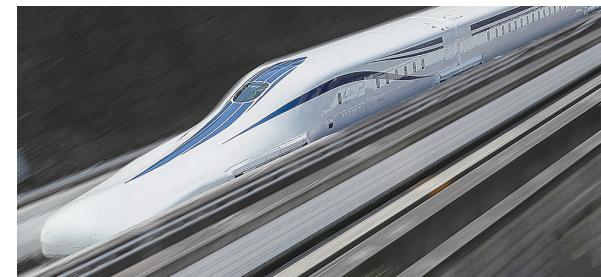
■山梨リニア実験線で走行試験中のL0(エル・ゼロ)系改良型試験車
